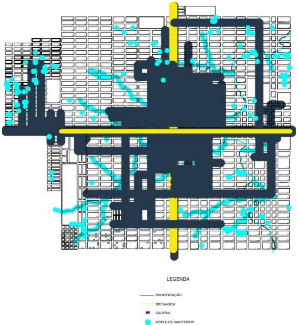
Figura 24 – Drenagem, Galerias e Pavimentação
